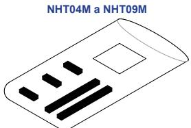
Fig. 3 - Identificación del conjunto de calzos de amortiguación
