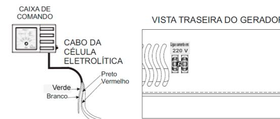
**Cable de la célula electrolítica, sensor de flujo:** Es el cable que alimenta la célula electrolítica para la realización de la electrolisis y también para la conexión del sensor de flujo.
