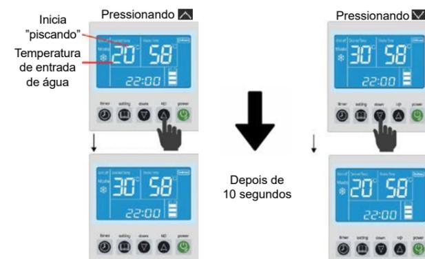
Configuração de temperatura da água, não pressione nenhum botão por 10 segundos, em seguida as configurações serão automaticamente salvas.
