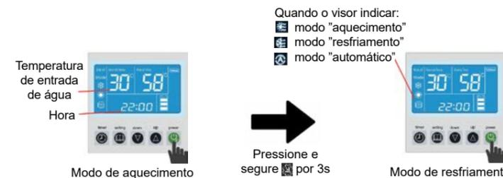
Após o desbloqueio, independentemente da operação da unidade ou do modo de espera, pode ser definida a temperatura da água desejada. Pressione "▲" ou "▼", o símbolo "Definir Temperatura" começa a piscar e exibe a temperatura definida da água, depois pressione a tecla "▲" ou "▼" para alterar a configuração da temperatura da água.
