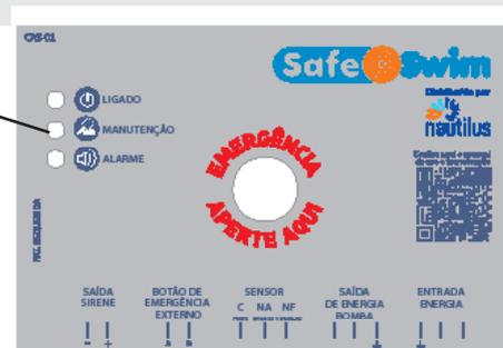
Ligar o equipamento e fechar suavemente a válvula (registro) do circuito hidráulico, onde o SafeSwim® está instalado. Antes do fechamento total da válvula, o equipamento deverá desligar a motobomba e acionar o alarme.
