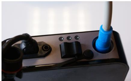
Inserte el extremo del cable flotante en el enchufe. Tenga cuidado con la orientación de la clavija y el enchufe.
