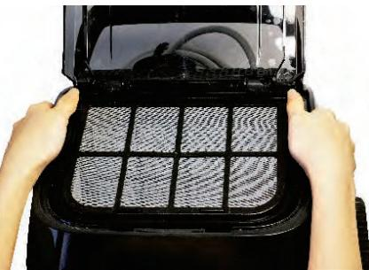
8.5 Depois de limpo, substitua a cesta no robô. Se o cesto não está alinhado corretamente, não é possível fechar a tampa do aspirador.
