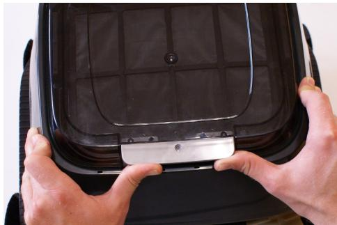
8.1 Abra a tampa na parte superior do robô, exercendo um impulso para cima com 2 dedos , a fim de abrir a tampa e acessar o cesto de filtro.
