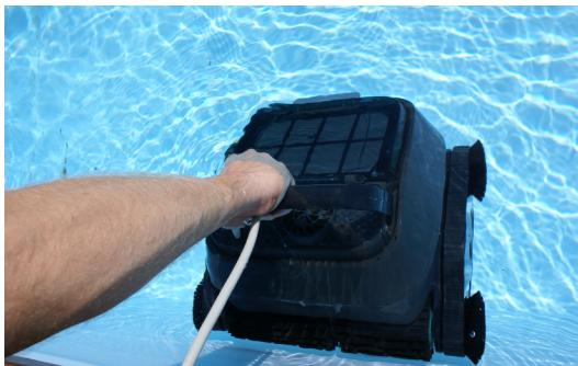
5.4 Coloque o robô na sua piscina e espere até que esteja completamente submerso. Se necessário, ajude-o a afundar manualmente.
