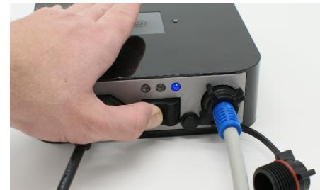
5.2 Atornille la tuerca del cable flotante firmemente. Pulse el interruptor de la armazón del transformador bajo la luz azul. Esto activará la fuente de energía.
