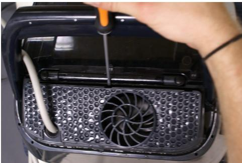
9.1. Use uma chave de fenda plana para remover a grade de proteção.
