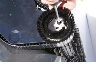
Utilice un destornillador para ajustar los cepillos laterales con los tornillos sin forzarlos
