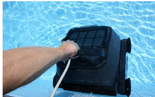
5.4 Coloque el robot en su piscina y espere hasta que esté totalmente sumergida. Si es necesario, ayúdelo a hundirse manualmente.
