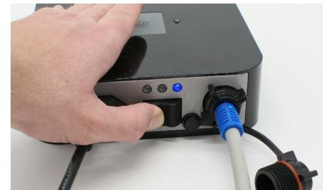
5.2 Rosqueie a porca do cabo flutuante com firmeza. Pressione o interruptor na caixa do transformador sob luz azul. Isso irá ativar a fonte de energia.
