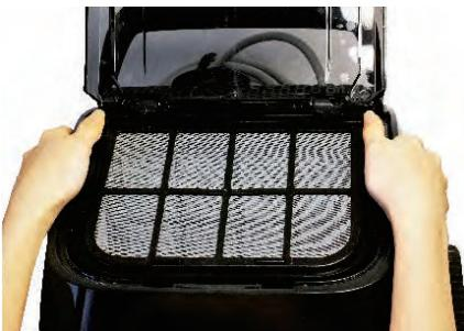
8.5 Una vez limpiado, vuelva a colocar la canasta en el robot. Si la canasta no está alineada correctamente, no es posible cerrar la tapa del limpiafondo.
