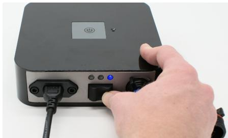
7.1 Conecte a fonte de alimentação a uma tomada elétrica próxima. Uma luz de azul deverá acender.
