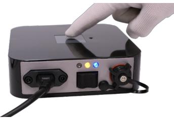
7.4 Pressione o botão liga / desliga localizado na parte superior da caixa para ativar o robô limpador.
