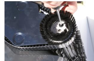
Fixe as escovas laterais com os parafusos, utilizando uma chave de parafusos. Não force!
