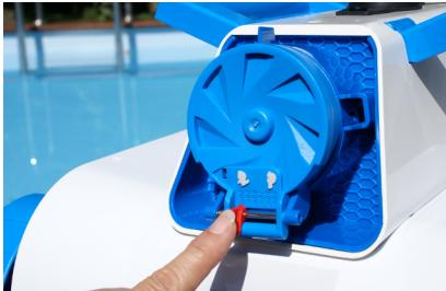
6.1 Para ajustar a direção do robô, rode a tampa da tomada. A direção do robô será determinada pela posição do indicador.
