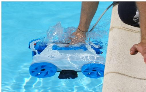
4.2 Coloque el robot en su piscina y espere hasta que esté totalmente sumergida. Si es necesario, ayúdela a hundirse manualmente.
