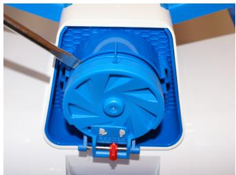
9.1: Remova a tampa para limpar a sujeira ou cabelos no rotor
