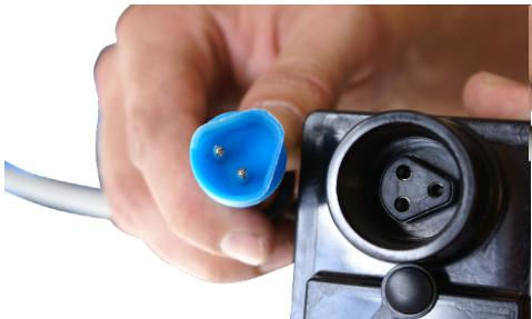
4.3 Insira a extremidade do cabo flutuante no soquete do transformador. Observe a orientação dos pinos
