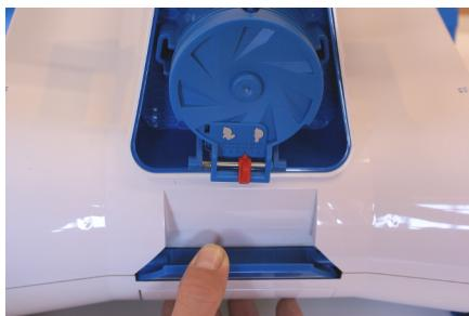
6.1 Pressione o botão na frente do robô e levante a tampa superior. Continue a levantar a tampa até ouvir um "clique" na dobradiça e a tampa ficará fixa.
