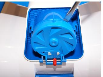
9.2: Use uma chave de fendas para remover a tampa conforme mostrado
