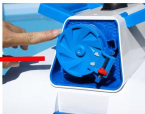
6.3 Para a maioria das piscinas, recomenda-se que a tampa de saída em ambas as extremidades não partilhe a mesma direção. Para obter um melhor desempenho, endireite a tampa na extremidade com as dobradiças de abertura e ajuste a tomada na frente do robô
