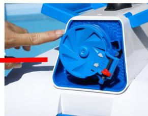
6.3 Para muchas piscinas se recomienda que la tapa de la toma de corriente de ambos extremos no comparta la misma dirección. Para el mejor rendimiento sitúe en posición recta la toma de corriente del extremo con bisagra y rote la de la parte delantera del limpiador.
