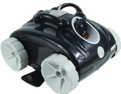
para retirar da piscina, levante o cabo de energia elétrica lenta e suavemente até que você possa pegá-lo pela alça. Use a alça para puxar completamente o robô.
