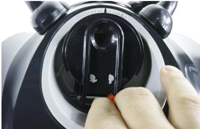
6.2 Para ajustar a velocidade do robô, mova o cursor na parte inferior da tampa. Se a opção for pelo símbolo do coelho a velocidade do robô aumenta; a escolha do símbolo da tartaruga a velocidade diminui.
