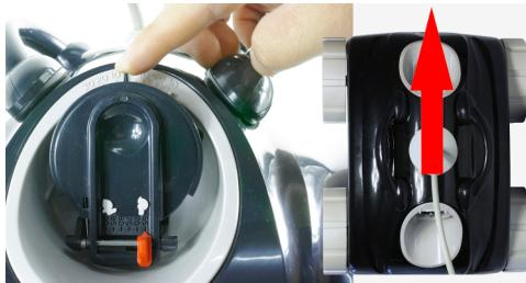
6.1 Para ajustar a direção do robô, rode a tampa da tomada. A direção do robô será determinada pela posição do indicador.
