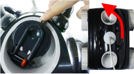
Nota: com o indicador na posição vertical, o robô irá seguir em frente. Com o indicador virado para a direita, o robô irá para a esquerda. Com o indicador virado para a esquerda, o robô irá para a direita.
