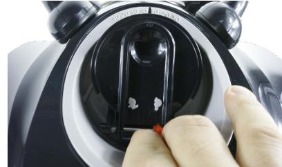
6.2 Para ajustar la velocidad del robot use un destornillador y gire el tornillo de la parte inferior de la tapa. Si lo desatornilla aumentará su velocidad y si lo atornilla la disminuirá.
