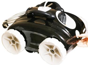
7.1 Pulse el botón que hay en la parte delantera del limpiafondos y levante la cubierta protectora superior hasta que escuche un «clac» en la bisagra y esta mantenga la cubierta en esa posición.
