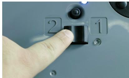
4.4 Atornille la tuerca del cable flotante firmemente. Pulse el interruptor de la armazón del transformador bajo la luz azul. Esto activará la fuente de energía.
