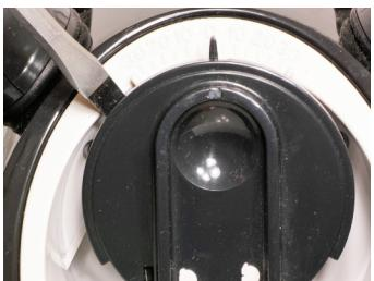
9.1: Remova a tampa para limpar a sujeira ou cabos no rotor
