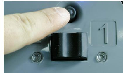
4.5 Pulse el botón de encendido situado en la parte superior de la caja para activar su robot.
