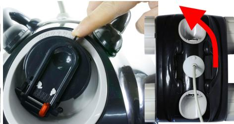
Nota: con el indicador en vertical el robot avanzará en línea recta. Girar el indicador a la derecha hará que se dirija hacia la izquierda y girarlo a la izquierda hará que se dirija hacia la derecha.
