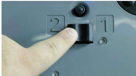
4.4 Rosqueie a porca do cabo flutuante com firmeza. Escolha o tempo no interruptor na caixa do transformador sob a luz azul, 1 ou 2 horas de limpeza. Isso irá ativar a fonte de energia.
