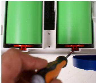
8.2: Se os detritos não forem de acesso fácil, use uma chave de fendas achatada para remover temporariamente os rolos. Empurre a aba conforme mostrado na imagem acima para remover o rolo.
