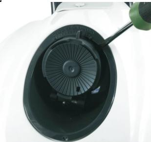
7.1: Retire la cubierta para limpiar el suciedad o pelo en el rotor
