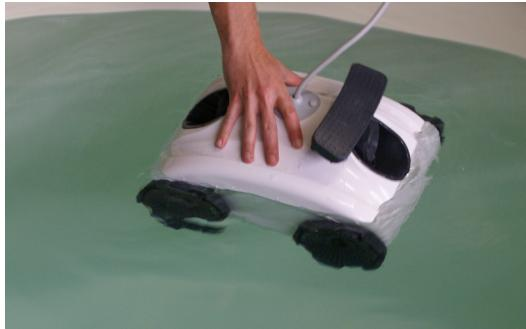
4.2 Coloque o robô na sua piscina e espere até que esteja completamente submerso. Se necessário, ajude-o a afundar manualmente.
