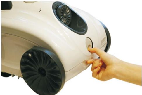
6.1 Pressione o botão na frente do robô e levante a tampa superior, até ouvir um "clique" na dobradiça e a tampa ficar fixa.
