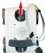
5.1 Para ajustar la dirección del robot róte la tapa de la toma de corriente. El indicador determina la
