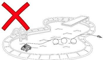
4.5 Não retire o seu robô da água imediatamente após o final do seu ciclo de limpeza para não causar um choque de temperatura.
