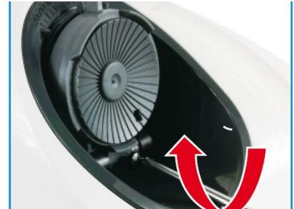
5.1 Para ajustar a direção do robô, rode a tampa da tomada. A direção do robô será determinada pela posição do indicador.
