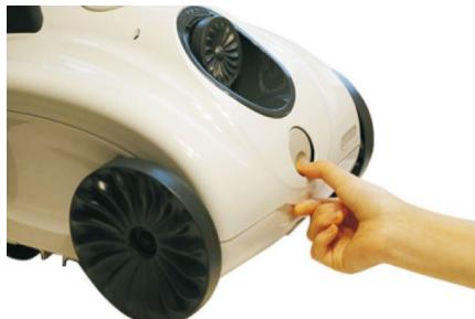
6.1 Pulse el botón que hay en la parte delantera del limpiador y levante la cubierta protectora superior hasta que escuche un «clac» en la bisagra y esta mantenga la cubierta en esa posición.
