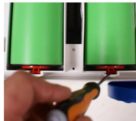
8.2: Si los escombros no son de fácil acceso, use un grietas aplanasadas para eliminar temporalmente los rodillos. Presione la pestaña como se muestra en la imagen de arriba para quitar el rollo
