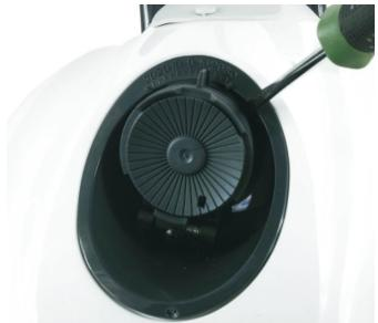
7.1: Remova a tampa para limpar a sujeira ou cabelos no rotor
