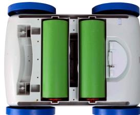
8.1: Girar manualmente los rodillos verde Deben rotar fácilmente. Si hay escombros de bloquear la rotación, quitar el escombros
