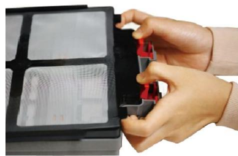
6.3 Levante as abas de plástico vermelhas de um lado e levante a tampa do cesto.
