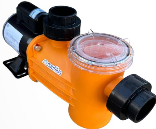
A motobomba centrífuga **PETRA**, é do tipo auto-escorvante, com pré-filtro incorporado, totalmente construídas em material termoplástico, com bocais de sucção e descarga adequados para tubulação de PVC abs colável de 50 mm no diâmetro interno, com uniões incorporadas.
