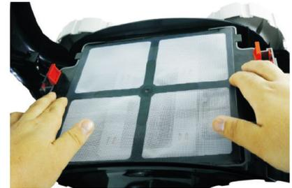
6.3 Levante as abas de plástico vermelhas de um lado e levante a tampa do cesto.
