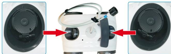
5.3 Para a maioria das piscinas, recomenda-se que a tampa de saída em ambas as extremidades não partilhe a mesma direção. Para obter um melhor desempenho, endireite a tampa na extremidade com as dobradiças de abertura e ajuste a tomada na frente do robô.
