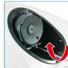
5.2 Para ajustar a velocidade do robô, use uma chave de fendas para girar o parafuso na parte inferior da tampa. Desenroscar aumenta a velocidade e enroscar diminui a velocidade.
