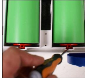
8.2 Se os detritos não forem de acesso fácil, use uma chave de fendas achatada para remover temporariamente os rolos. Empurre a aba conforme mostrado na imagem acima para remover o rolo.
