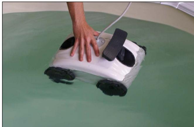
4.2 Coloque o robô na sua piscina e espere até que esteja completamente submerso. Se necessário, ajude-o a afundar manualmente.
