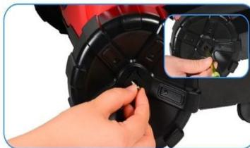
4. Conecte o cabo curto do robô ao dispositivo flutuante anti-torção de cabo. Insira o plug da extremidade do cabo flutuante na tomada. Tenha cuidado com a polaridade do plug e da tomada. O plug deve ser encaixado delicadamente. Deslize a tampa em direção à caixa anti-torção de cabo. Esta tampa ajuda a manter o cabo e a vedação da conexão de forma apropriada.
