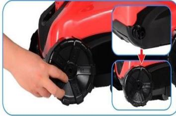
2. Coloque o suporte quadrado no eixo da roda. Ele foi projetado para uma única posição. Gire-o levemente até que ele se encaixe na ranhura.
