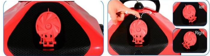
O robô funcionará em linha reta se o ponteiro da tampa da saída estiver na posição vertical.
