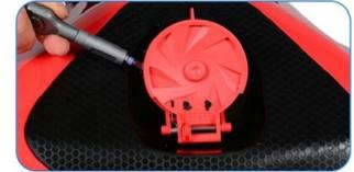
2. Sugere-se forçar igualmente cada lado para fora. Trabalhe em toda a volta, se necessário. O conjunto da aba deve ser removido com facilidade.
