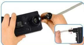
9. Parafuse a porca do cabo longo na fonte de alimentação para que a conexão fique segura
