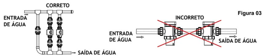
Em casa de máquinas onde não seja possível a instalação do by-pass, alocar o gerador de cloro na linha de retorno após o filtro conforme imagem ao lado:
