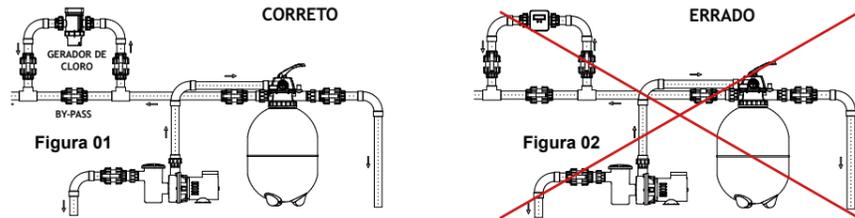
Quando utilizar mais de um gerador de cloro ou a vazão do sistema filtrante for maior que a admitida pelo gerador, deve-se fazer um sistema em paralelo com by-pass, conforme figura abaixo:
